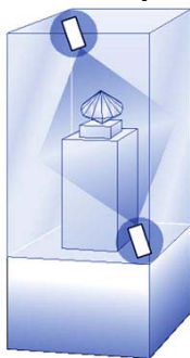
Рисунок 39 – Пример установки извещателя «Витрина» в охраняемом объеме
